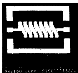
图2 实验制作的 MEMS 微电感
